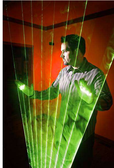
Laserharp, inclusief Wiimote voor het bepalen van de handafstand en daarmee toonhoogte
