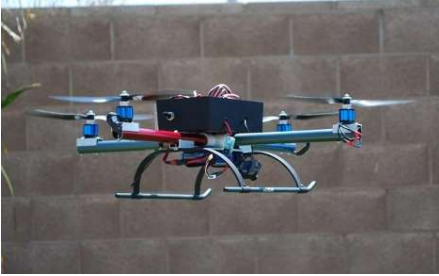
AeroQuad, een quadcopter met een Arduino als boordcomputer
