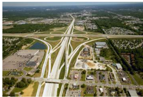
Figuur 2 Een typisch knooppunt waar overgangsbogen gebruikt zijn.
